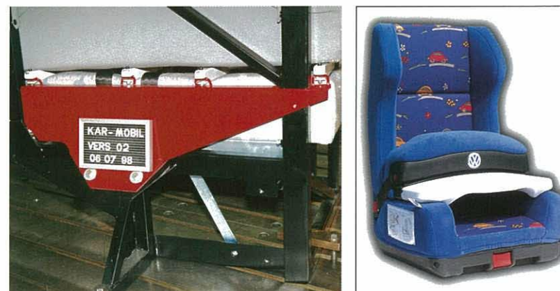
In enger Abstimmung mit VW bietet Karmann-Mobil als erster Hersteller im Reisemobilbereich die „ISOFIX“-Befestigung für Kindersitze an. Crashtests bewiesen: Mehr Sicherheit durch „ISOFIX“. Die Greifarme des Kindersitzes rasten in die speziell von Karmann-Mobil entwickelten Aufnahmepunkte ein und geben sicheren Halt, auch in extremen Fahrsituationen. Das „ISOFIX“-Befestigungssystem macht die Montage des Kindersitzes so einfach wie das Schließen eines Reißverschlusses (Sonderausstattung).
