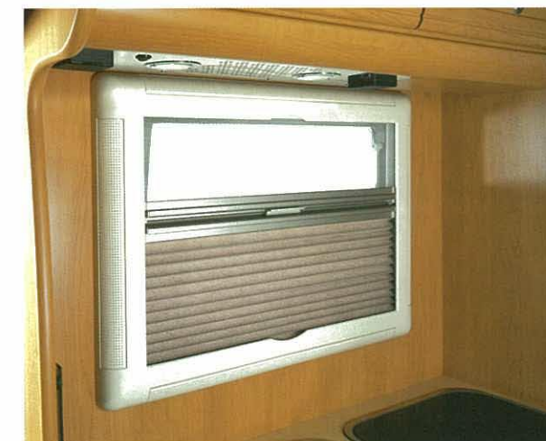
Fenster mit komfortabler Einhandbedienung und Mückenschutz finden Sie in allen Missouri-Modellen. Die Fächer-Jalousie schützt durch ihre äußere Aluminium-Beschichtung vor starker Sonneneinstrahlung.
