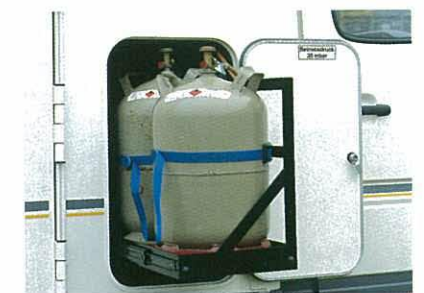
Ein Rollenauszug macht das Auswechseln der zwei 11-kg-Gasflaschen besonders einfach.
