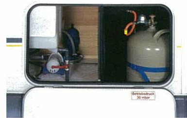
Bequem von außen zugänglich: Beim Missouri 600 H finden zwei 11-kg-Gasflaschen Platz im dafür vorgesehenen, nach innen abgedichteten Raum im Heck.
