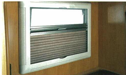
Die Fächer-Jalousie schützt durch ihre äußere Aluminium-Beschichtung vor starker Sonneneinstrahlung. Jalousie und Mückenschutz lassen sich in jeder Stellung arretieren.
