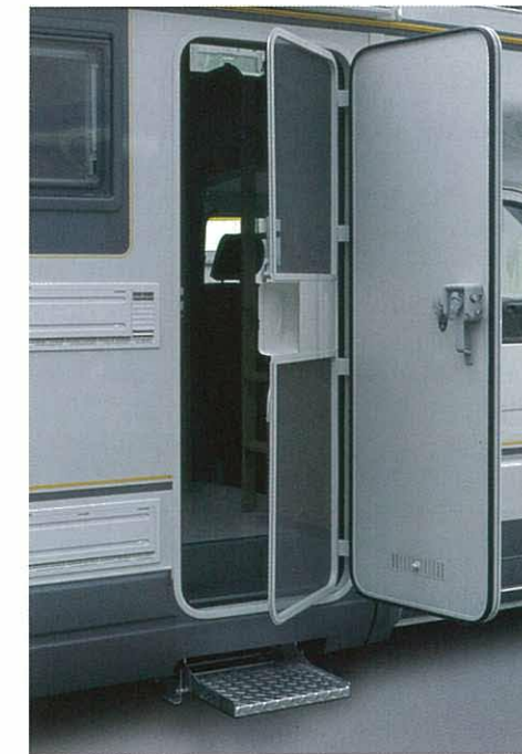
Ausgestattet mit einem soliden Sicherheitschloss: die extrabreite Aufbau­tür der Missouri-Modelle. Das serienmäßige integrierte Fliegengitter lässt Frischluft herein und hält Mücken draußen.
